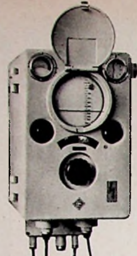
Außen- und Innenansicht des Anzeigergerätes der „Fischlupe“. Rechts: zwei typische Schirmbilder; die seitlichen starken Auslenkungen weisen auf Fischschwärme in der an einer Skala ablesbaren Tiefe hin. Das obere Bild zeigt z. B. noch deutlich größere Fischschwärme dicht über dem Grund
