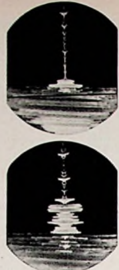
Außen- und Innenansicht des Anzeigergerätes der „Fischlupe“. Rechts: zwei typische Schirmbilder; die seitlichen starken Auslenkungen weisen auf Fischschwärme in der an einer Skala ablesbaren Tiefe hin. Das obere Bild zeigt z. B. noch deutlich größere Fischschwärme dicht über dem Grund
